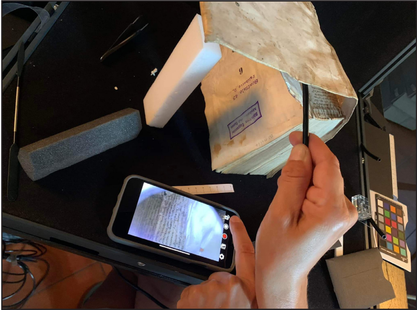
Figura 1: Rilevamento di un frammento riutilizzato in un dorso grazie all'impiego della sonda endoscopica (foto: Marina Bernasconi Reusser)
